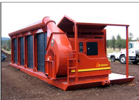
Selvstyret bevilgede i 2014 ekstraordinært 2 mio. kr. til oprydning af lossepladsen i Maniitsoq. For en del af midlerne blev indkøbt en Air Burner til afbrænding af byggeaffald og storskrald. I 2015 og 16 er afbrændt store mængder træ- og byggeaffald i Air Burneren.
